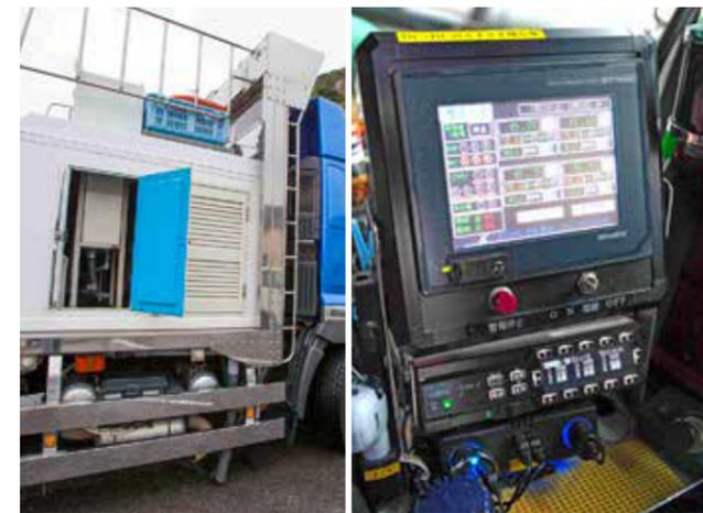
Была спроектирована компактная система фильтрации. Этот экран позволяет водителю проверять состояние системы фильтрации
