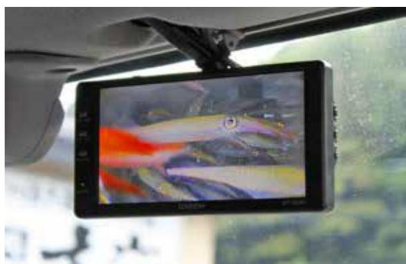
Экран над водительским сиденьем обеспечивает обзор того, что происходит внутри резервуара
