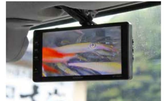
Экран над водительским сиденьем обеспечивает обзор того, что происходит внутри резервуара
